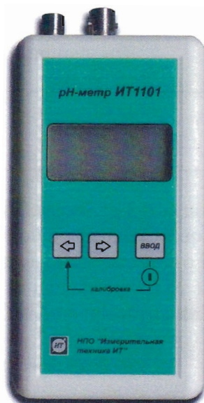
Рис.1. Фотография внешнего вида рН-метр ИТ-1101.
