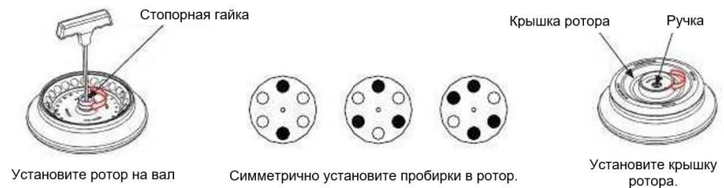
Рисунок 8-2. Установка ротора
