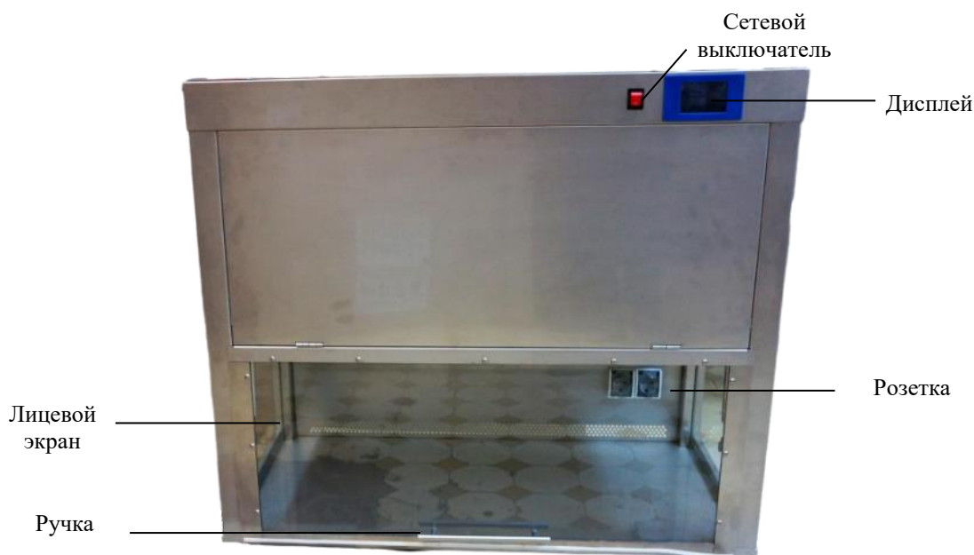
Рисунок 2 – Устройство и основные части бокса (вид спереди)
