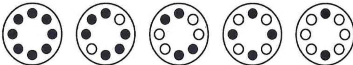
Рисунок 7 – Пример симметричной загрузки ротора
