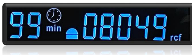
Рисунок 9 – Выбор значения относительного центробежного ускорения
