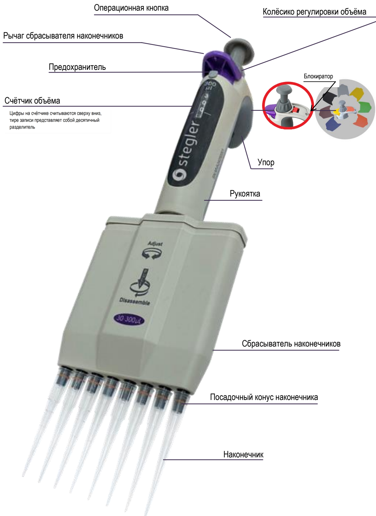
Рисунок 15 – Составные части дозатора на примере модели: Дозатор 8-канальный с переменным объемом дозирования (30-300 мкл) MVA-8-30-300
