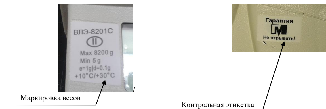
Рисунок 2 - Схема пломбирования от несанкционированного доступа и маркировка весов
